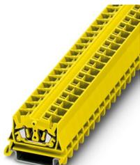
Minimorsetto passante, tensione nominale: 800 V, corrente nominale: 24 A, numero di connessioni: 4, tipo di connessione: Connessione a molla, Sezione di dimensionamento: 2,5 mm<sup>2</sup>, 1. piano, sezione: 0,08 mm<sup>2</sup> - 4 mm<sup>2</sup>, tipo di montaggio: NS 35/7,5, NS 35/15, colore: giallo
