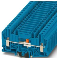
Morsetto sezionatore, tensione nominale: 1000 V, corrente nominale: 41 A, tipo di connessione: Connessione a vite, 1. piano, Sezione di dimensionamento: 6 mm<sup>2</sup>, sezione: 0,2 mm<sup>2</sup> - 10 mm<sup>2</sup>, tipo di montaggio: NS 35/7,5, NS 35/15, NS 32, colore: blu
