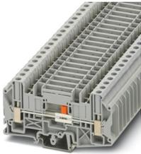
Morsetto sezionatore, tensione nominale: 1000 V, corrente nominale: 41 A, tipo di connessione: Connessione a vite, Sezione di dimensionamento: 6 mm<sup>2</sup>, sezione: 0,2 mm<sup>2</sup> - 10 mm<sup>2</sup>, tipo di montaggio: NS 35/7,5, NS 35/15, NS 32, colore: grigio
