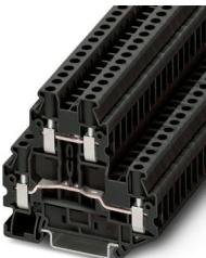
Morsetto passante a due piani, tensione nominale: 800 V, corrente nominale: 30 A, tipo di connessione: Connessione a vite, 1. e 2. piano, Sezione di dimensionamento: 4 mm<sup>2</sup>, sezione: 0,14 mm<sup>2</sup> - 6 mm<sup>2</sup>, tipo di montaggio: NS 35/7,5, NS 35/15, colore: nero
