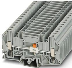
Morsetto sezionatore, con supporto a molla, tensione nominale: 1000 V, corrente nominale: 41 A, tipo di connessione: Connessione a vite, 1. piano, Sezione di dimensionamento: 6 mm<sup>2</sup>, sezione: 0,2 mm<sup>2</sup> - 10 mm<sup>2</sup>, tipo di montaggio: NS 35/7,5, NS 35/15, NS 32, colore: grigio
