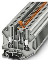
Morsetto con sezionatore a coltello, con viti per prese di prova per l'alloggiamento di spine di prova, tensione nominale: 500 V, corrente nominale: 20 A, 1. piano, tipo di connessione: Connessione a vite con supporto a molla, Sezione di dimensionamento: 4 mm<sup>2</sup>, sezione: 0,2 mm<sup>2</sup> - 6 mm<sup>2</sup>, montaggio: NS 35/7,5, NS 35/15, NS 32, colore: grigio
