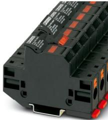
Portafusibili, tipo fusibile: gPV 10,3 x 38 mm secondo 60269-6, tensione nominale: 1000 V DC, corrente nominale: 20 A, tipo di connessione: Connessione Push-in, Sezione di dimensionamento: 10 mm<sup>2</sup>, sezione: 1,5 mm<sup>2</sup>- 10 mm<sup>2</sup>, tipo di montaggio: NS 35/7,5, NS 35/15, colore: nero
