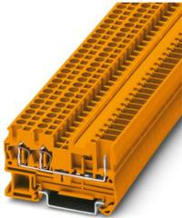
Morsetto passante, tensione nominale: 500 V, corrente nominale: 24 A, numero di connessioni: 3, numero poli: 1, tipo di connessione: Connessione a molla/a innesto, Sezione di dimensionamento: 2,5 mm<sup>2</sup>, 1. Piano attacco sinistra, sezione: 0,08 mm<sup>2</sup> - 4 mm<sup>2</sup>, 1. piano, collegamento a destra, tipo di montaggio: NS 35/7,5, NS 35/15, colore: arancione
