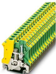
Morsetto per conduttori di terra, numero di connessioni: 2, numero poli: 1, tipo di connessione: Connessione a vite, sezione: 1,5 mm<sup>2</sup> - 6 mm<sup>2</sup>, tipo di fissaggio: Piedino PE con vite di fissaggio M4, tipo di montaggio: NS 35/7,5, NS 35/15, NS 32, colore: giallo-verde
