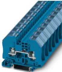
Morsetto passante con connessione a bullone e calotta trasparente, sezione: 0,1 – 6 mm<sup>2</sup>, AWG: 26 - 10, larghezza 16,3 mm, colore: blu
