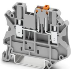
Morsetto con sezionatore a coltello, tensione nominale: 500 V, corrente nominale: 20 A, Corrente continua termica  $I_{th}$ : 20 A, tipo di connessione: Connessione a vite, Sezione di dimensionamento: 2,5 mm<sup>2</sup>, sezione: 0,14 mm<sup>2</sup> - 4 mm<sup>2</sup>, montaggio: NS 35/7,5, NS 35/15, colore: grigio
