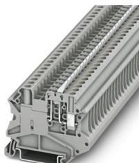
Morsetto con sezionatore a coltello, con linguetta di azionamento, sezionatore a coltello bianco e viti per prese di prova per l'alloggiamento di spine di prova, tensione nominale: 500 V, corrente nominale: 20 A, tipo di connessione: Connessione a vite, Sezione di dimensionamento: 2,5 mm<sup>2</sup>, sezione: 0,14 mm<sup>2</sup> - 6 mm<sup>2</sup>, montaggio: NS 35/7,5, NS 35/15, colore: grigio
