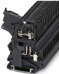
Morsetto portafusibili, tipo di fusibile: Vetro / ceramica / ..., tipo fusibile: G / 5 x 20, tensione nominale: 500 V, corrente nominale: 6,3 A, tipo di connessione: Connessione a vite, Sezione di dimensionamento: 4 mm<sup>2</sup>, sezione: 0,14 mm<sup>2</sup>- 6 mm<sup>2</sup>, tipo di montaggio: NS 35/7,5, NS 35/15, colore: nero
