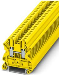
Morsetto passante, tensione nominale: 1000 V, corrente nominale: 32 A, numero di connessioni: 2, tipo di connessione: Connessione a vite, Sezione di dimensionamento: 4 mm<sup>2</sup>, sezione: 0,14 mm<sup>2</sup> - 6 mm<sup>2</sup>, tipo di montaggio: NS 35/7,5, NS 35/15, colore: giallo
