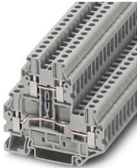
Morsetto passante a due piani, tensione nominale: 800 V, corrente nominale: 30 A, tipo di connessione: Connessione a vite, 1. e 2. piano, Sezione di dimensionamento: 4 mm<sup>2</sup>, sezione: 0,14 mm<sup>2</sup> - 6 mm<sup>2</sup>, tipo di montaggio: NS 35/7,5, NS 35/15, colore: arancione
