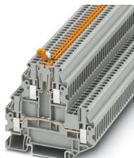
Morsetto con sezionatore a coltello, con viti per prese di prova per l'alloggiamento di spine di prova, tensione nominale: 400 V, corrente nominale: 22 A, tipo di connessione: Connessione a vite, Sezione di dimensionamento: 2,5 mm<sup>2</sup>, sezione: 0,14 mm<sup>2</sup> - 4 mm<sup>2</sup>, tipo di connessione: Connessione a vite, Sezione di dimensionamento: 2,5 mm<sup>2</sup>, sezione: 0,14 mm<sup>2</sup> - 4 mm<sup>2</sup>, montaggio: NS 35/7,5, NS 35/15, colore: grigio
