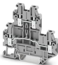
Morsetto passante a due piani, tensione nominale: 500 V, corrente nominale: 24 A, tipo di connessione: Connessione a vite, Sezione di dimensionamento: 2,5 mm<sup>2</sup>, sezione: 0,14 mm<sup>2</sup> - 4 mm<sup>2</sup>, tipo di montaggio: NS 35/7,5, NS 35/15, colore: grigio
