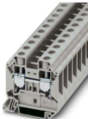
Morsetto passante, tensione nominale: 1000 V, corrente nominale: 76 A, numero di connessioni: 2, tipo di connessione: Connessione a vite, Sezione di dimensionamento: 16 mm<sup>2</sup>, sezione: 1,5 mm<sup>2</sup> - 25 mm<sup>2</sup>, tipo di montaggio: NS 35/7,5, NS 35/15, colore: grigio
