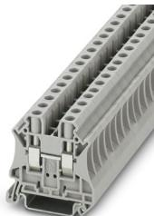
Morsetto passante, tensione nominale: 1000 V, corrente nominale: 41 A, numero di connessioni: 2, tipo di connessione: Connessione a vite, Sezione di dimensionamento: 6 mm<sup>2</sup>, sezione: 0,2 mm<sup>2</sup> - 10 mm<sup>2</sup>, tipo di montaggio: NS 35/7,5, NS 35/15, colore: grigio
