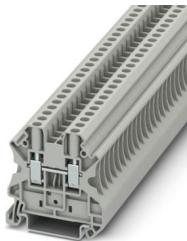
Morsetto passante, tensione nominale: 1000 V, corrente nominale: 32 A, numero di connessioni: 2, tipo di connessione: Connessione a vite, Sezione di dimensionamento: 4 mm<sup>2</sup>, sezione: 0,14 mm<sup>2</sup> - 6 mm<sup>2</sup>, tipo di montaggio: NS 35/7,5, NS 35/15, colore: grigio
