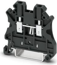
Morsetti per schermatura, con superficie testa stampata in nero, tensione nominale: 48 V, tipo di connessione: Connessione a vite, Sezione di dimensionamento: 2,5 mm<sup>2</sup>, sezione: 0,14 mm<sup>2</sup> - 4 mm<sup>2</sup>, tipo di montaggio: NS 35/7,5, NS 35/15, colore: nero
