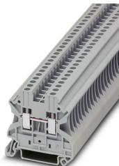
Morsetto passante, tensione nominale: 1000 V, corrente nominale: 24 A, numero di connessioni: 2, tipo di connessione: Connessione a vite, Sezione di dimensionamento: 2,5 mm<sup>2</sup>, sezione: 0,14 mm<sup>2</sup> - 4 mm<sup>2</sup>, tipo di montaggio: NS 35/7,5, NS 35/15, colore: grigio
