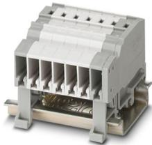
Giunto COMBI, tensione nominale: 500 V, corrente nominale: 24 A, numero di connessioni: 1, tipo di connessione: Connessione a molla, Sezione di dimensionamento: 2,5 mm<sup>2</sup>, sezione: 0,08 mm<sup>2</sup> - 4 mm<sup>2</sup>, tipo di montaggio: NS 35/7,5, NS 35/15, colore: grigio
