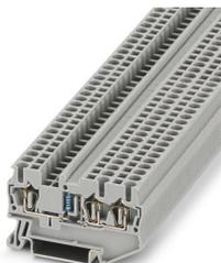
Componente morsetto componibile, tensione nominale: 800 V, corrente nominale: 0,5 A, numero di connessioni: 3, tipo di connessione: Connessione a molla, Sezione di dimensionamento: 1 mm<sup>2</sup>, 1. piano, sezione: 0,08 mm<sup>2</sup> - 4 mm<sup>2</sup>, tipo di montaggio: NS 35/7,5, NS 35/15, colore: grigio
