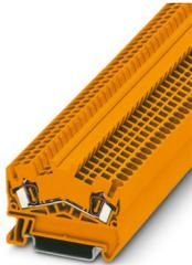
Morsetto passante, tensione nominale: 800 V, corrente nominale: 24 A, numero di connessioni: 2, tipo di connessione: Connessione a molla, Sezione di dimensionamento: 2,5 mm<sup>2</sup>, 1. piano, sezione: 0,08 mm<sup>2</sup> - 4 mm<sup>2</sup>, tipo di montaggio: NS 35/7,5, NS 35/15, colore: arancione
