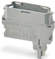
Spina porta componenti, per il montaggio di componenti selezionabili a piacere fino a un diametro di 10 mm e una potenza dissipata max. di 1 W, tensione nominale: 400 V, corrente nominale: 10 A, tipo di connessione: Attacco connettore, profondità: 37,5 mm, larghezza: 12,3 mm, altezza: 41,2 mm, numero poli: 1, colore: grigio, tipo di montaggio: a innesto (Slot)
