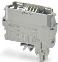
Spina porta componenti, pensato per l'alloggiamento del diodo SKN 2,5, tensione nominale: 400 V, corrente nominale: 1,25 A, tipo di connessione: Attacco connettore, profondità: 37,5 mm, larghezza: 12,3 mm, altezza: 41,2 mm, numero poli: 1, colore: grigio, tipo di montaggio: a innesto (Slot)
