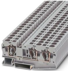
Morsetto passante, tensione nominale: 1000 V, corrente nominale: 41 A, numero di connessioni: 3, tipo di connessione: Connessione a molla, Sezione di dimensionamento: 6 mm<sup>2</sup>, sezione: 0,2 mm<sup>2</sup> - 10 mm<sup>2</sup>, tipo di montaggio: NS 35/7,5, NS 35/15, colore: grigio
