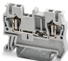
Morsetto passante, per il montaggio di componenti selezionabili a piacere, tensione nominale: 800 V, corrente nominale: 24 A, numero di connessioni: 2, tipo di connessione: Connessione a molla, Sezione di dimensionamento: 2,5 mm<sup>2</sup>, 1. piano, sezione: 0,08 mm<sup>2</sup> - 4 mm<sup>2</sup>, tipo di montaggio: NS 35/7,5, NS 35/15, colore: grigio
