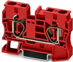
Morsetto passante componibile, tensione nominale: 1000 V, corrente nominale: 57 A, numero di connessioni: 2, tipo di connessione: Connessione a molla, Sezione di dimensionamento: 10 mm<sup>2</sup>, 1. piano, sezione: 0,2 mm<sup>2</sup> - 16 mm<sup>2</sup>, tipo di montaggio: NS 35/7,5, NS 35/15, colore: rosso
