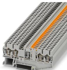
Morsetto con sezionatore a coltello, con sezionatore a coltello ruotato di 180°, tensione nominale: 400 V, corrente nominale: 20 A, tipo di connessione: Connessione a molla, Sezione di dimensionamento: 2,5 mm<sup>2</sup>, sezione: 0,08 mm<sup>2</sup> - 4 mm<sup>2</sup>, montaggio: NS 35/7,5, NS 35/15, colore: grigio
