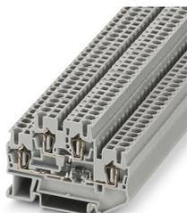
Componente morsetto componibile, con diodo integrato 1N4007, corrente nominale: 0,5 A, 1. e 2. piano, tipo di connessione: Connessione a molla, Sezione di dimensionamento: 2,5 mm<sup>2</sup>, sezione: 0,08 mm<sup>2</sup> - 4 mm<sup>2</sup>, montaggio: NS 35/7,5, NS 35/15, colore: grigio
