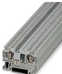
Componente morsetto componibile, con diodo integrato, corrente nominale: 1,5 A, tipo di connessione: Connessione a molla, Sezione di dimensionamento: 4 mm<sup>2</sup>, sezione: 0,08 mm<sup>2</sup> - 6 mm<sup>2</sup>, montaggio: NS 35/7,5, NS 35/15, colore: grigio
