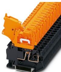
Morsetti sezionatori con leva, tensione nominale: 500 V, corrente nominale: 20 A, numero di connessioni: 2, tipo di connessione: Connessione a molla, Sezione di dimensionamento: 2,5 mm<sup>2</sup>, sezione: 0,08 mm<sup>2</sup> - 6 mm<sup>2</sup>, tipo di montaggio: NS 35/7,5, NS 35/15, colore: blu
