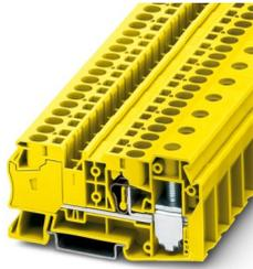
Morsetto ripartitore di potenziale, tensione nominale: 1000 V, corrente nominale: 41 A, Presa, tipo di connessione: Connessione a molla, Sezione di dimensionamento: 6 mm<sup>2</sup>, sezione: 0,2 mm<sup>2</sup> - 10 mm<sup>2</sup>, Connessione collettiva, tipo di connessione: Connessione a vite, Sezione di dimensionamento: 35 mm<sup>2</sup>, sezione: 1,5 mm<sup>2</sup> - 50 mm<sup>2</sup>, montaggio: NS 35/7,5, NS 35/15, colore: giallo
