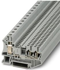
Morsetto ripartitore di potenziale, tensione nominale: 800 V, corrente nominale: 55 A, tipo di connessione: Connessione a vite, Sezione di dimensionamento: 10 mm<sup>2</sup>, sezione: 0,5 mm<sup>2</sup> - 16 mm<sup>2</sup>, tipo di connessione: Connessione a molla, Sezione di dimensionamento: 2,5 mm<sup>2</sup>, sezione: 0,08 mm<sup>2</sup> - 4 mm<sup>2</sup>, montaggio: NS 35/7,5, NS 35/15, colore: grigio
