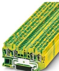
Morsetti comp. per conduttori terra, numero di connessioni: 4, tipo di connessione: Connessione a molla, Sezione di dimensionamento: 2,5 mm<sup>2</sup>, sezione: 0,08 mm<sup>2</sup> - 4 mm<sup>2</sup>, tipo di montaggio: NS 35/7,5, NS 35/15, colore: giallo-verde
