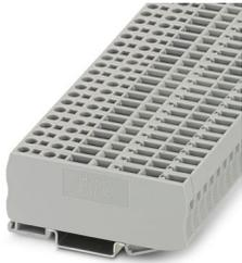
Morsetto passante, con coperchio, tensione nominale: 500 V, corrente nominale: 24 A, numero di connessioni: 4, tipo di connessione: Connessione a molla/a innesto, Sezione di dimensionamento: 2,5 mm<sup>2</sup>, sezione: 0,08 mm<sup>2</sup> - 4 mm<sup>2</sup>, 1. Piano attacco sinistra, tipo di montaggio: NS 35/7,5, NS 35/15, colore: grigio
