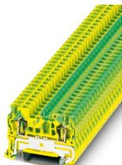
Morsetto a molla per conduttori di terra, numero di connessioni: 2, tipo di connessione: Connessione a molla, Sezione di dimensionamento: 2,5 mm<sup>2</sup>, sezione: 0,08 mm<sup>2</sup> - 4 mm<sup>2</sup>, tipo di montaggio: NS 35/7,5, NS 35/15, colore: giallo-verde
