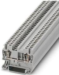
Morsetto passante, tensione nominale: 800 V, corrente nominale: 24 A, numero di connessioni: 2, numero poli: 1, tipo di connessione: Connessione a molla, Sezione di dimensionamento: 2,5 mm<sup>2</sup>, sezione: 0,08 mm<sup>2</sup> - 4 mm<sup>2</sup>, tipo di montaggio: NS 35/7,5, NS 35/15, colore: grigio
