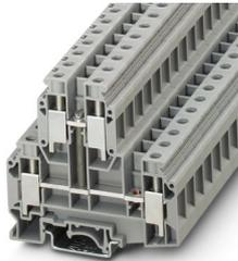
Morsetto passante a due piani, con ripartitore di potenziale, tensione nominale: 500 V, corrente nominale: 57 A, tipo di connessione: Connessione a vite, 1. e 2. piano, Sezione di dimensionamento: 10 mm<sup>2</sup>, sezione: 0,5 mm<sup>2</sup> - 16 mm<sup>2</sup>, Sezione di dimensionamento: 10 mm<sup>2</sup>, tipo di montaggio: NS 35/7,5, NS 35/15, NS 32, colore: grigio
