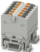
Blocco distributore, Blocco con orientamento orizzontale, tensione nominale: 500 V, corrente nominale: 17,5 A, numero di connessioni: 12, tipo di connessione: Connessione Push-in, sezione: 0,14 mm<sup>2</sup> - 2,5 mm<sup>2</sup>, tipo di montaggio: NS 15, colore: grigio
