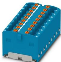
Blocco distributore, tensione nominale: 450 V, corrente nominale: 17,5 A, numero di connessioni: 18, tipo di connessione: Connessione Push-in, sezione: 0,14 mm<sup>2</sup> - 2,5 mm<sup>2</sup>, tipo di montaggio: incollare, colore: blu
