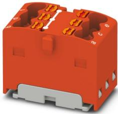
Blocco distributore, ponticellato internamente, tensione nominale: 450 V, corrente nominale: 17,5 A, numero di connessioni: 6, tipo di connessione: Connessione Push-in, sezione: 0,14 mm<sup>2</sup> - 2,5 mm<sup>2</sup>, tipo di montaggio: montaggio su adattatori per il fissaggio su guida di supporto, Montaggio diretto con flangia, Mobile, colore: rosso
