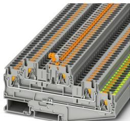
Morsetto sezionatore, tensione nominale: 500 V, corrente nominale: 30 A, tipo di connessione: Connessione Push-in, Sezione di dimensionamento: 4 mm<sup>2</sup>, sezione: 0,2 mm<sup>2</sup> - 6 mm<sup>2</sup>, tipo di connessione: Connessione Push-in, Sezione di dimensionamento: 4 mm<sup>2</sup>, sezione: 0,2 mm<sup>2</sup> - 6 mm<sup>2</sup>, montaggio: NS 35/7,5, NS 35/15, colore: grigio
