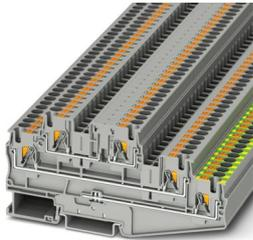
Morsetto a più piani, tensione nominale: 500 V, corrente nominale: 30 A, tipo di connessione: Connessione Push-in, Sezione di dimensionamento: 4 mm<sup>2</sup>, sezione: 0,2 mm<sup>2</sup> - 6 mm<sup>2</sup>, tipo di connessione: Connessione Push-in, Sezione di dimensionamento: 4 mm<sup>2</sup>, sezione: 0,2 mm<sup>2</sup> - 6 mm<sup>2</sup>, tipo di montaggio: NS 35/7,5, NS 35/15, colore: grigio
