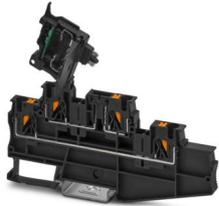
Morsetto portafusibili, tipo di fusibile: Vetro / ceramica / ..., tipo fusibile: G / 5 x 20, tensione nominale: 500 V, corrente nominale: 28 A, tipo di connessione: Connessione Push-in, Sezione di dimensionamento: 4 mm<sup>2</sup>, sezione: 0,2 mm<sup>2</sup>- 6 mm<sup>2</sup>, tipo di connessione: Connessione Push-in, Sezione di dimensionamento: 4 mm<sup>2</sup>, sezione: 0,2 mm<sup>2</sup>- 6 mm<sup>2</sup>, tipo di montaggio: NS 35/7,5, NS 35/15, colore: nero
