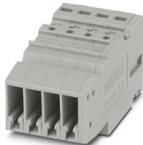
Giunto COMBI, tensione nominale: 500 V, corrente nominale: 24 A, numero di connessioni: 4, numero poli: 4, tipo di connessione: Connessione Push-in, Sezione di dimensionamento: 2,5 mm<sup>2</sup>, 1. piano, sezione: 0,14 mm<sup>2</sup> - 4 mm<sup>2</sup>, colore: grigio
