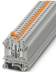
Morsetto con sezionatore a coltello, tensione nominale: 500 V, corrente nominale: 16 A, tipo di connessione: Connessione a vite, Sezione di dimensionamento: 1,5 mm<sup>2</sup>, sezione: 0,2 mm<sup>2</sup> - 6 mm<sup>2</sup>, montaggio: NS 35/7,5, NS 35/15, NS 32, colore: grigio
