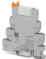
PLC-INTERFACE, composta da morsetto base PLC-BSC.../21 con connessione a vite e relè in miniatura a innesto, con contatto in oro multistrato, per il montaggio su guida di montaggio NS 35/7,5, 1 contatto di scambio, tensione di ingresso 220 V DC
